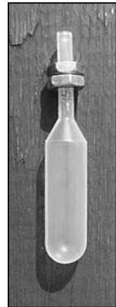
Ua ana kaumaha 'ia ke omo ho'okulu ea me nā pihi keleawe i mea e piholo ka mea lu'u Cartesian.
